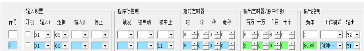
图中设置第 2 行 Y1 为脉冲出端, 第 2 行 Y2 为方向输出端, 设置步进电机工作 8 秒钟。X1 启动电机工作后, 运行 8 秒钟第 1 行定时结束 Y2 停止输出, 同时中止第 2 行的脉冲输出 Y1 的工作, 两行同时停止达到定时控制的功能。
