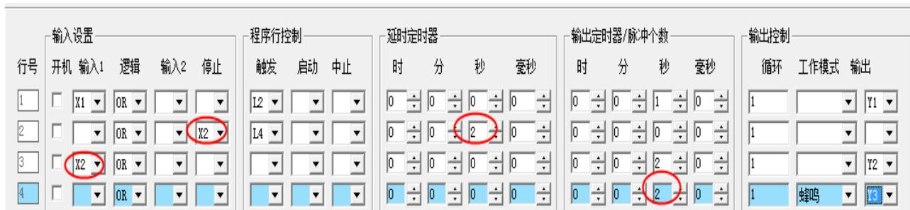
图中设置第 1 行由 X1 启动 Y1 工作 1 秒钟，工作结束触发第 2 行 L2，第 2 行设置的是超时 2 秒钟不到位报警的功能，设置延时定时器 2 秒钟作为超时报警的时间，X2 是检测到位的感应开关。
