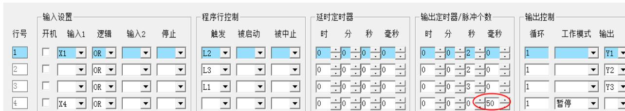
暂停时关闭输出工作方式的设置方法很简单，只是在暂停程序行的输出定时器设置 50 毫秒的定时作为标志，系统会将其识别为关闭输出的暂停方式。
