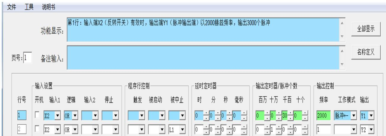
上图是步进电机反转: 由 X2 启动步进电机以 2000 赫兹的频率 (速度) 反转 3000 个脉冲, 脉冲结束运行自动停止。这个方法可以通过设置脉冲数, 实现步进电机反向运行一定的长度或角度。
