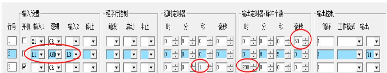
图中，第 1 行的 X1 是感应开关，上电时输入端 X1 在位有效，会误启动程序工作，下面介绍具体措施：
