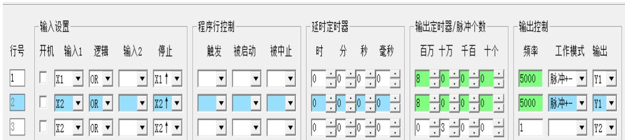
开关 X1 是正转按钮开关, X2 是反转按钮开关, 按下 X1 开关正向运行, 松开开关立即停止。按下 X2 开关反向运行, 松开开关立即停止。
