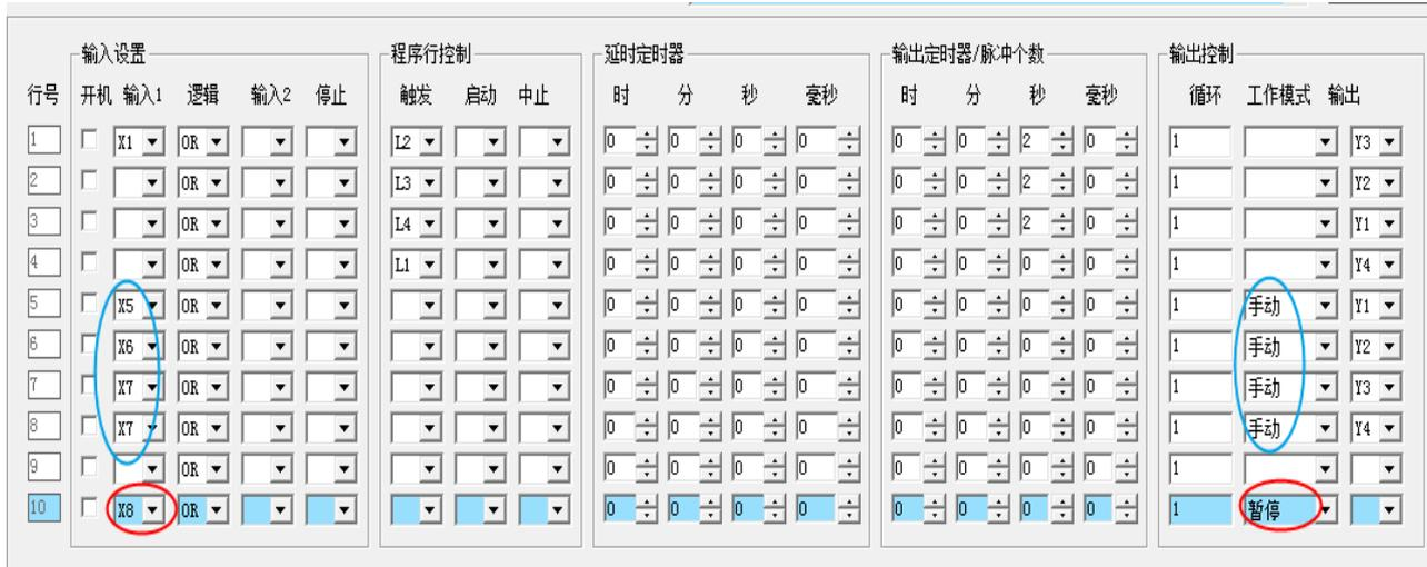
图中第 10 行设置了暂停工作模式，X8 是最后一个输入端，当 X8 有效后全部程序暂停执行，此时可以使用手控方式直接对输出端进行手动操作。第 5—8 行设置了手控开关 X5、X6 和 X7，直接对输出端 Y1、Y2、Y3 和 Y4 进行操作。
