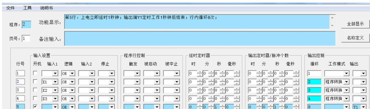
这是第二套程序的设置, 第 2、3、4 行分别设置用开关 X1、X2、X3 切换第 1、2、3 套程序, 第 5 行设置的是上电启动本套程序 Y1 工作的示意, 代表本套上电启动的程序。
