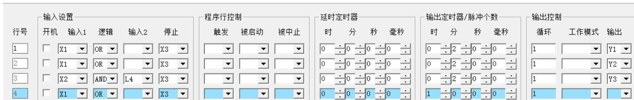
在第 3 行输入 2 设置了 L4，将第 4 行作为逻辑关系的控制行，当 X3 停止开关有效是关闭前 3 行的输出，同时也关闭了第 4 行的逻辑控制行，使第 2 行的逻辑关系失效，禁止了回程感应开关信号的作用。
