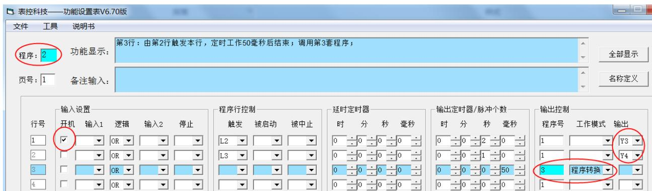
第 2 套程序设置为开机启动，转换过来立即工作。程序号设置为程序 2，执行完毕转为执行第 3 套程序设置为程序转换程序号 3，输出设置为 Y3 工作 2 秒钟后触发第 2 行 Y4 工作 1 秒钟，工作结束后触发第 3 行程序转换为第 3 套程序。
