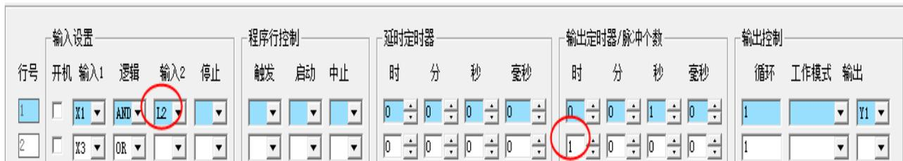
图中设置使用行号 L2 限制输入 1 的输入，使用行号限制另一个输入端，只有行号 L2 输出定时器处于工作状态的时候输入 1 才有效。此例设置第 2 行由 X3 来启动输出定时器工作 1 小时，在这个时间内第 1 行的输入 1 有效，否则输入 1 的 X1 被禁止。
