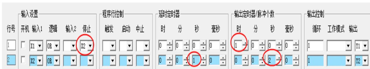
图中做了一个气缸行程位置控制的示例, 正向运行到感应开关位置时停止 1 秒钟, 然后气缸返回到原位。
