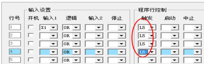
上图所示，只有触发才能这样设置第 1、2、3、4 行触发同一行，用启动是无法设置的。
