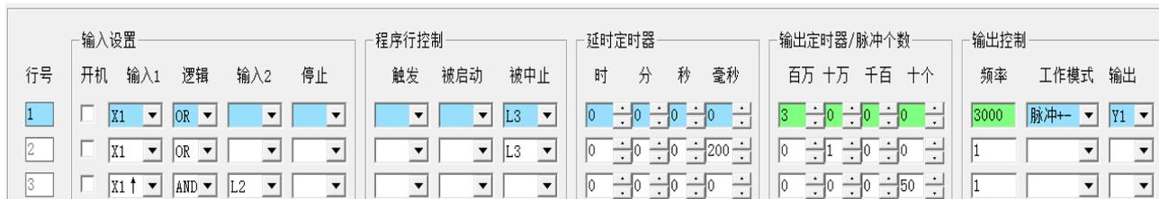
设置的原理是利用延时避开开关抖动的这个过程，经过分析，这个程序开关 X1 的启动过程抖动是没有影响的，X1 一旦启动第 1 行程序工作，在工作没有结束前开关的抖动对启动是没有任何影响的，在这里表控可以非常杰出地抗拒这个抖动的干扰。但是抖动对后沿关闭的影响是很大的，因此这里主要解决抖动对后沿停止的影响。
