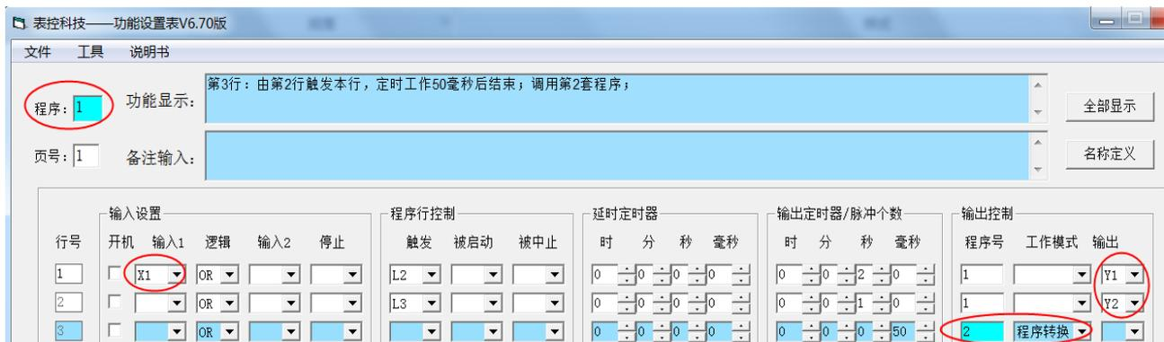
第 1 套程序设置为有 X1 启动，程序号设置为程序 1，执行完毕转为执行第 2 套程序设置为程序转换程序号 2，输出设置为 Y1 工作 2 秒钟后触发第 2 行 Y2 工作 1 秒钟，工作结束后触发第 3 行程序转换为第 2 套程序。
