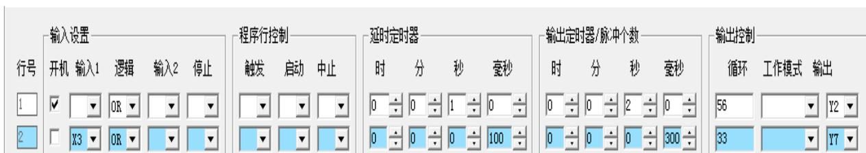
图中展示了本行循环的设置方法，一共设置了两行。第 1 行设置了开机启动延时 1 秒 Y2 输出 2 秒，执行行内循环 56 次。
