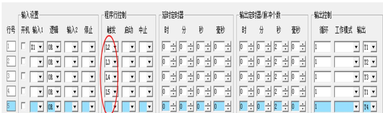
图中，X1 启动后执行第 1 行 Y1 工作，第 1 行工作结束触发第 2 行 L2，以此类推直到执行到最后的第 5 行后自动结束。其中，Y1 工作了两次，这是允许的，可以设置任何行执行多次动作。
