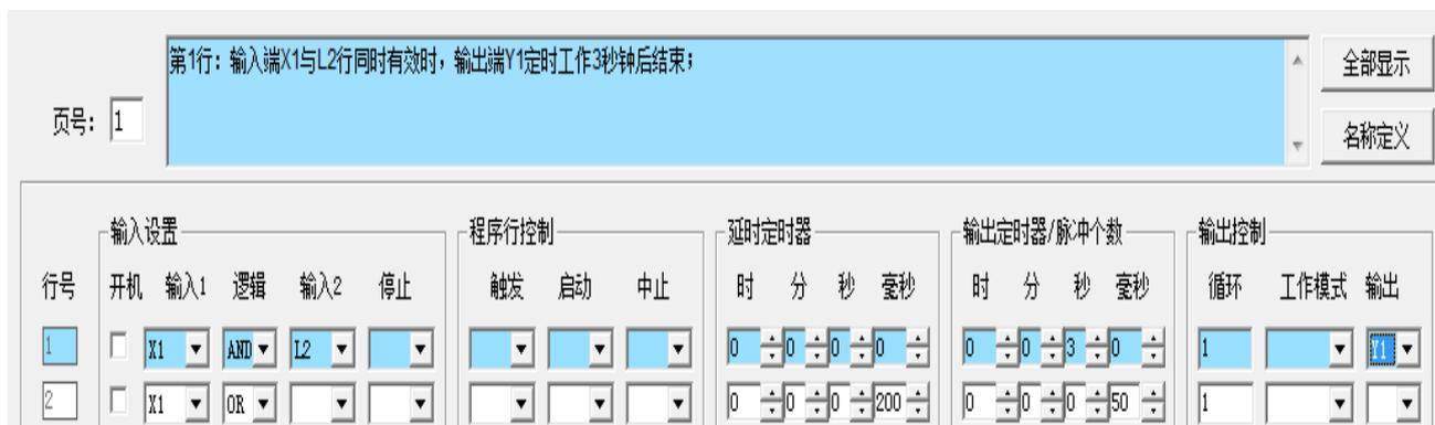
上图中 X1 是启动开关, 同时启动两行, 第 2 行延时 200 毫秒后输出定时器工作 50 毫秒, 作为第 1 行输入 2 的“与”AND 条件。由于第 1 行设置了 X1 和 L2 的“与”逻辑关系, X1 有效之后 200 毫秒之内是被禁止的, 当 200 毫秒后第 2 行输出定时器工作 50 毫秒的时候, X1 才被允许有效, Y1 执行输出工作 3 秒钟的动作。
