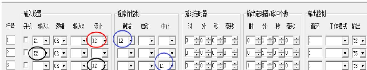
上图设置第 1 行触发第 2 行 L2，第 3 行也由第 1 行 L1 来中止。当第 1 行停止项设置 X2 有效时，第 1 行被强制停止运行，参看第 1 行红圈的部位。被强迫停止的第 1 行中的触发和中止功能随之失效，参看蓝圈的部位。
