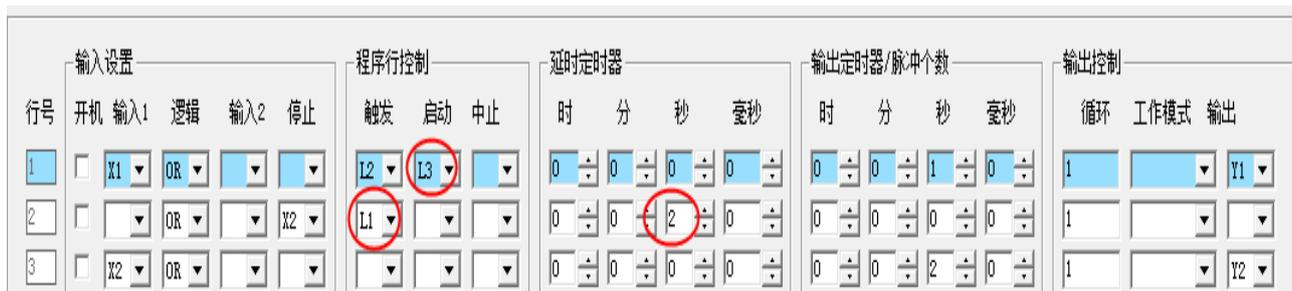
图中设置与上述工作原理相同，只是处理报警的措施不同。在于第 2 行的触发项设置为触发第 1 行 L1，重新执行第 1 行的动作。此功能很适合上料控制，如果超时没有检测到物料，则重复执行第 1 行的上料动作。正常情况感应开关 X2 到位后执行第 3 行 Y2 输出 2 秒钟，然后自动启动第 1 行，重新执行循环动作。循环动作由第 1 行设置的启动项 L3 实现。
