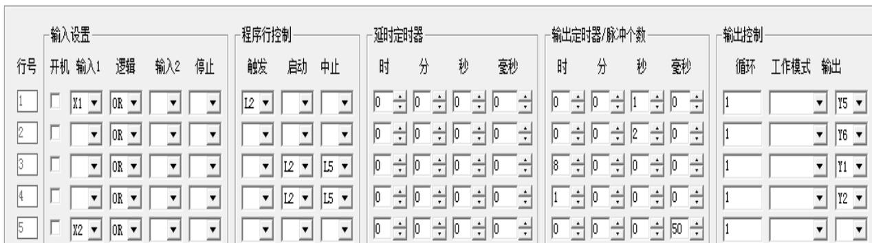
图中设置第 1、2 行代表正在运行的程序，第 3、4 行设置为由第 2 行工作结束来启动步进电机反向运行，第 5 行设置到达原位感应开关 X2 时中止第 3、4 行的脉冲输出端 Y1 和 Y2 的方向控制端，步进电机停止在原始
