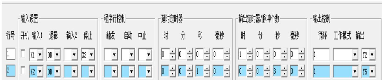
图中设置了最简单的示例，X1 是感应开关 1，X2 是感应开关 2，感应开关可以是磁性开关、接近开关、光电开关等各种开关量传感器，还可以是微动开关及行程开关等接点式开关。
