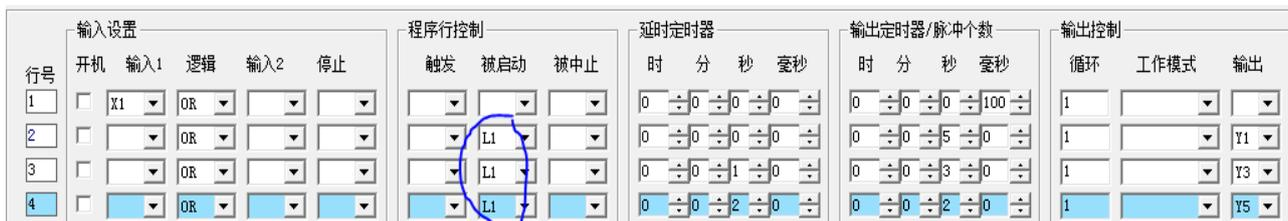
图中第 1 行设置 X1 来启动, 第 2、3、4 行的被启动项设置了行号 L1, 第 1 行设置的 100 毫秒工作结束后这三行同时被第 1 行启动。被启动是个常用的启动多行的命令, 可以同时启动多行程序同时工作。
