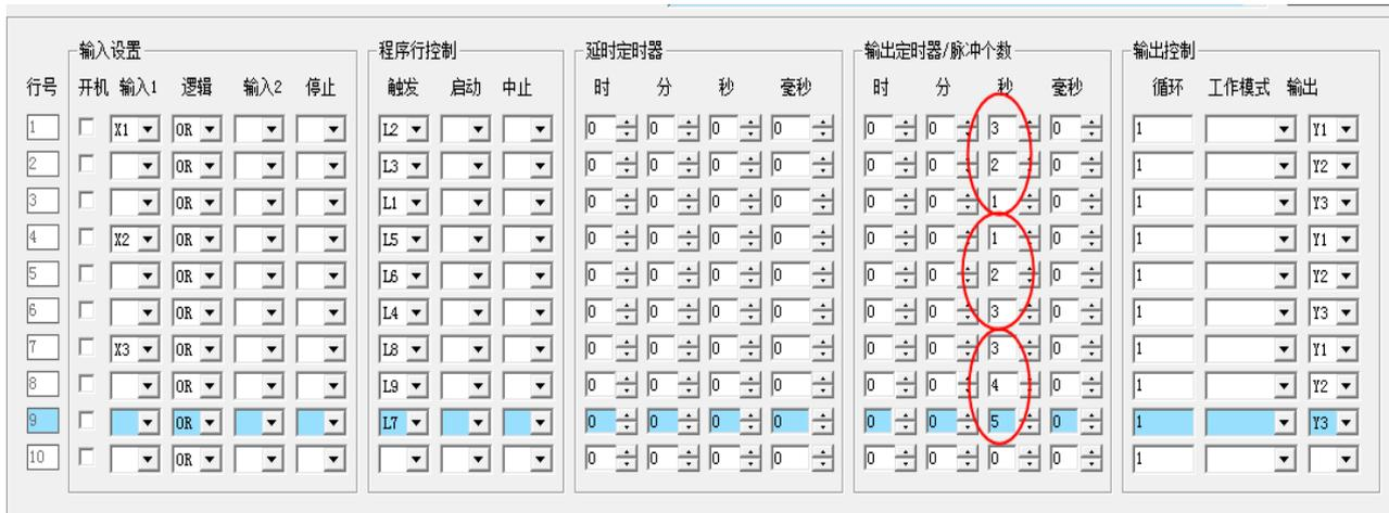
图中设置 3 段程序分别有 X1、2X 和 X3 来启动，每段程序的输出相同、功能一样，只是延时时间不同。
