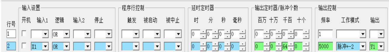
上图 X1 是启动开关，Y1 是脉冲输出端，频率设置为 5000，脉冲数设置为 6400。步进电机驱动器的细分可以设置为 1600、3200 或 6400，细分不同转的圈数也不同。细分设置为 1600 转 4 圈，设置为 3200 转 2 圈，设置为 6400 时转 1 圈。以上细分适合步距角为 1.8° 的步进电机参考。
