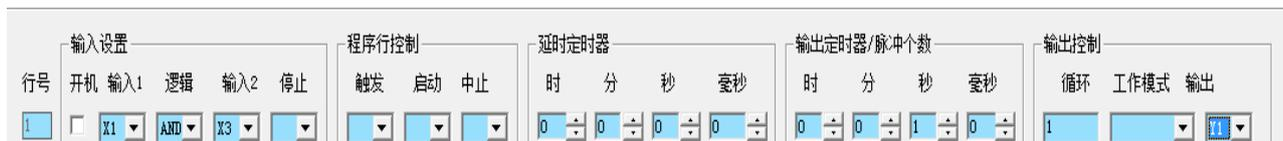
图中设置使用 X3 开关限制输入端 X1 的输入，使用输入开关限制另一个输入端，只有 X3 有效时才允许 X1 输入起作用。
