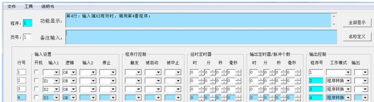
这是第一套程序的设置, 没有设置工作程序, 仅作为开关转换工作, 这是设置原理的关键。上电后首先进入的是默认的第一套程序, 第 2、3、4 行分别设置开关 X1、X2、X3 专门作为切换第 1、2、3 套程序。
