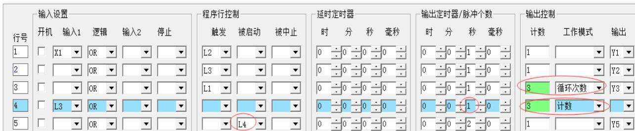
图中设置第 4 行对第 3 行 L3 计数 3 次, 循环 3 次后计数也到达 3 次, 第 4 行经过定时 1 秒结束后, 正好与循环结束时间相同, 启动第 5 行 Y5 工作 2 秒钟。
