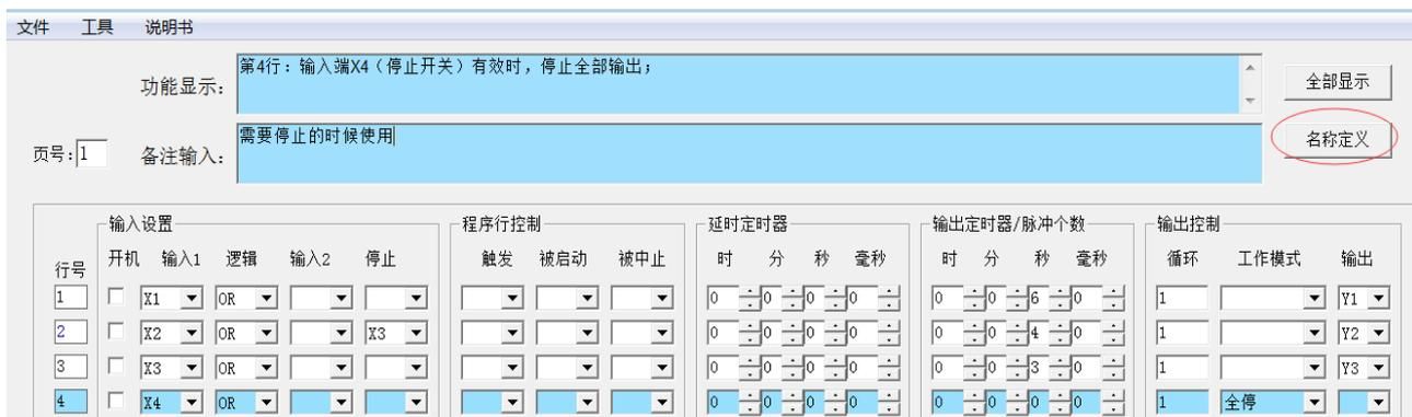
进入名称定义界面, 根据输入端和输出端的作用和接入的器件, 给输入端和输出端命名合适的名称。这样便于记忆, 在设置的时候不容易混淆, 并且在自动生成的汉字说明中也同步加入, 便于对设置功能的解读。
