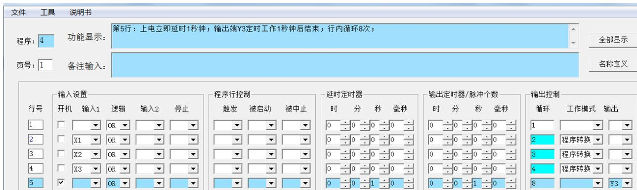
这是第四套程序的设置, 第 2、3、4 行分别设置用开关 X1、X2、X3 切换第 1、2、3 套程序, 第 5 行设置的是上电启动本套程序 Y3 工作的示意, 代表本套上电启动的程序。
