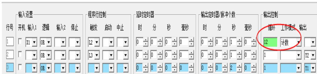
图中是对输入端计数的示例，X1 是感应开关，第 1 行设置对 X1 计数 12 次，计数到达 12 次触发第 2 行，以及执行第 3 行等其他功能。需要控制什么动自行设置即可。
