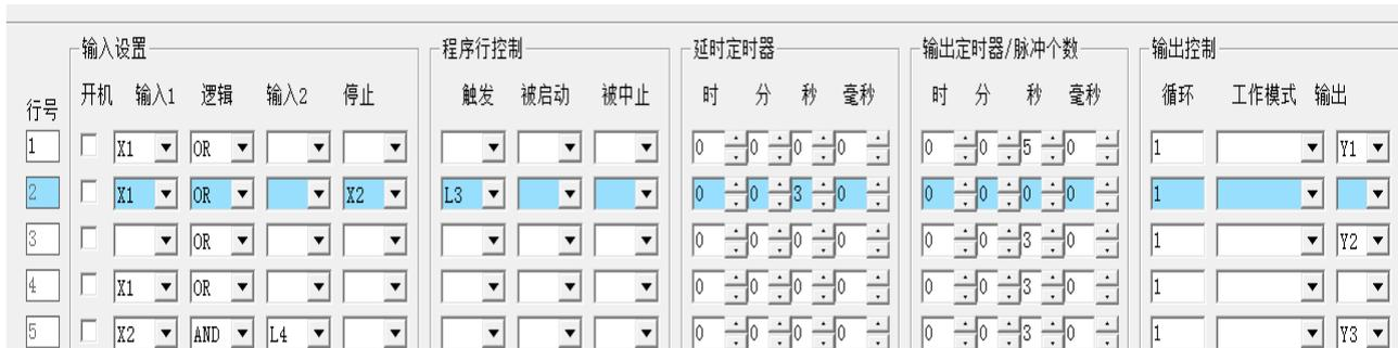
第 1 行：输入端 X1（启动开关）有效时，输出端 Y1（气缸 1）工作 5 秒钟；
