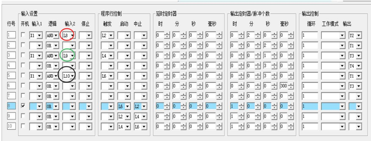
图中设置有三个不同功能, 由开关 X1 按照按键次数来分别启动。此例每个步进只有两行程序, 举例说明设置原理, 实际应用中每个步进可由多行组成, 灵活运用。
