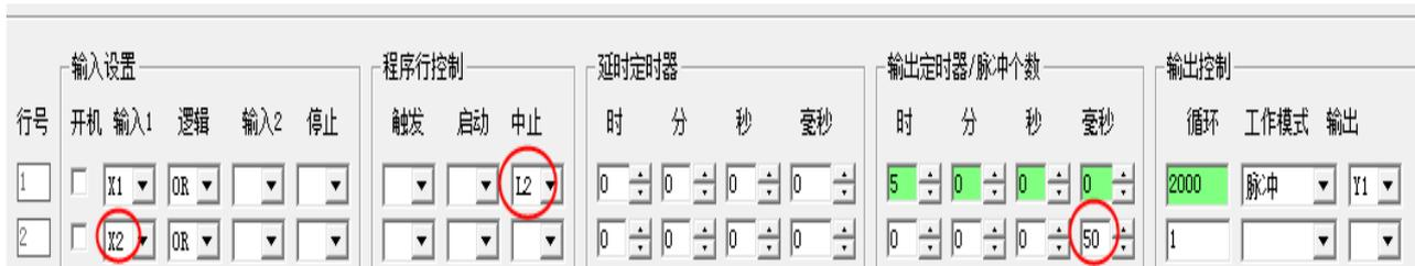
图中设置了最简单的位置控制功能, X1 是启动开关, X2 是位置控制的感应开关, Y1 长时间输出 2000 赫兹频率转速的脉冲, 这里设置为 500 万个脉冲可使电机长时间转动。
