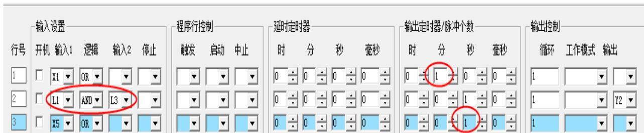
图中第 2 行输入 1 的 L1 限制输入 2 的 L3，当第 1 行和第 3 行的输出定时器同时有效时第 2 行被启动，Y2
