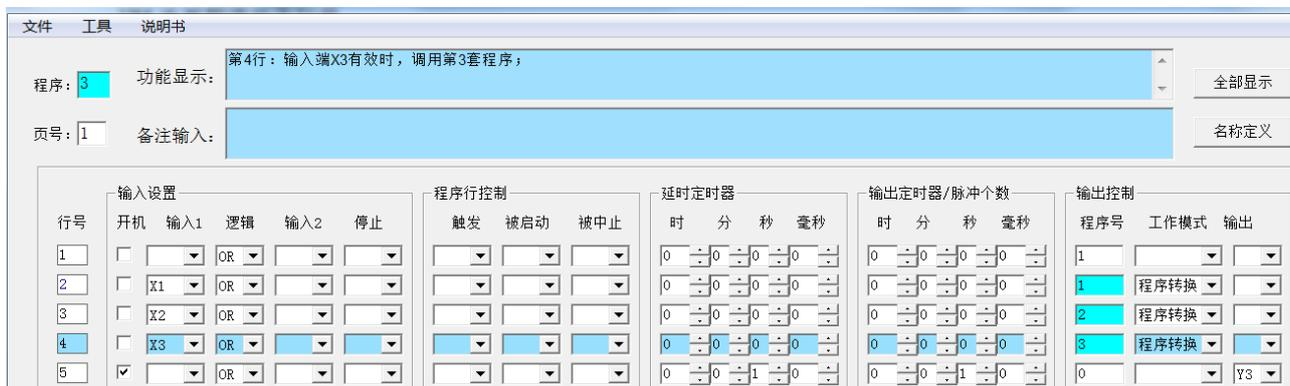
这是第三套程序的设置示例, 第 2、3、4 行分别设置用开关 X1、X2、X3 切换第 1、2、3 套程序, 第 5 行设置的是上电启动本套程序 Y3 工作的示意, 代表本套上电启动的程序。
