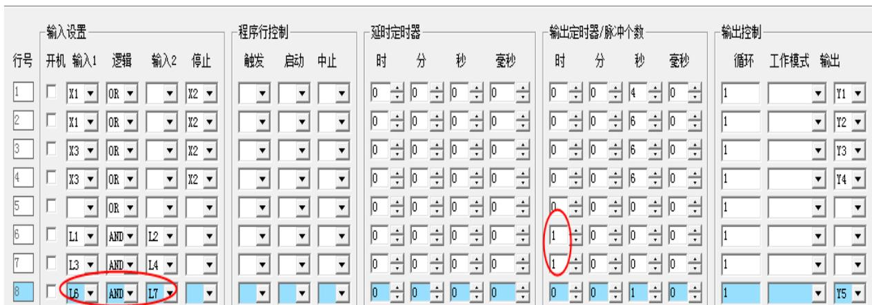
图中 X1 和 X3 是启动开关，X2 是停止开关，第 1—4 行做了一个用开关启动和停止程序行工作的简单动作。用逻辑“与”来判断 4 行程序是否全部工作。
