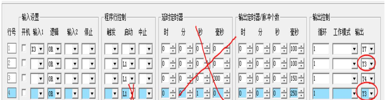
图中第 1 行和第 3 行设置有 Y3 输出，这两行都设置了由第一行 L1 来启动，即设置了同时启动相同的输出端，这样的设置致使程序无法正常工作。程序不可能同时执行对 Y3 的两个延时和定时，因此这个程序设置失败。
