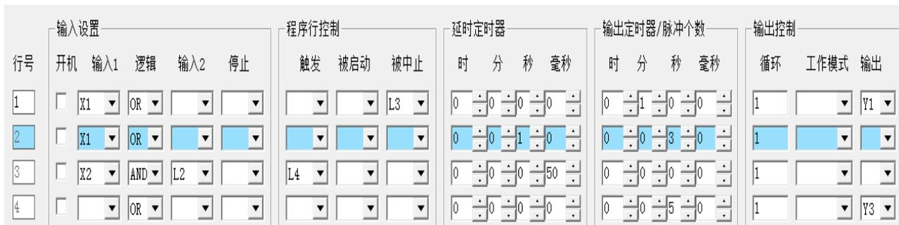
图中设置第 1 行启动的同时也启动第 2 行延时 1 秒钟后输出 3 秒钟，作为第 3 行感应开关 X2 逻辑与的条件，延时 1 秒期间第 3 行的输入 2 设置的 L2 无效，此时 X2 的信号被屏蔽不起作用了，1 秒钟后第 2 行的输出定时器工作时 L2 的条件有效，可以正常工作到位停止 Y1 和触发第 4 行的 Y3 工作。
