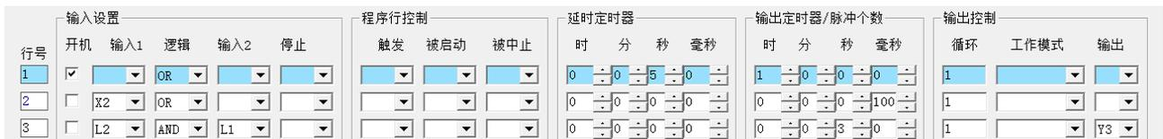
第 1 行设置上电启动，延时 5 秒钟后工作定时设置 1 秒钟，作为控制输入信号是否有效的条件。
