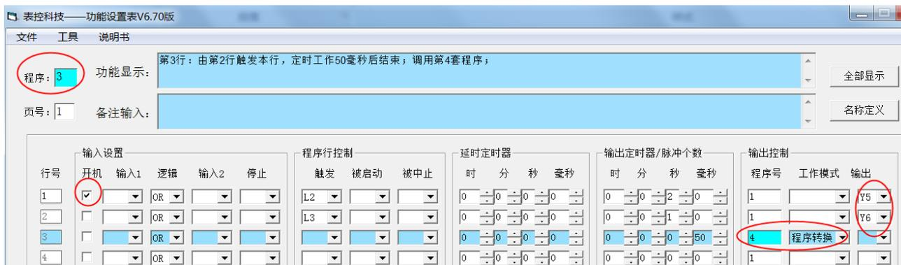
第 3 套程序设置为开机启动, 转换过来立即工作。程序号设置为程序 3, 执行完毕转为执行第 4 套程序设置为程序转换程序号 4, 输出设置为 Y5 工作 2 秒钟后触发第 2 行 Y6 工作 1 秒钟, 工作结束后触发第 3 行程序转换为第 4 套程序。
