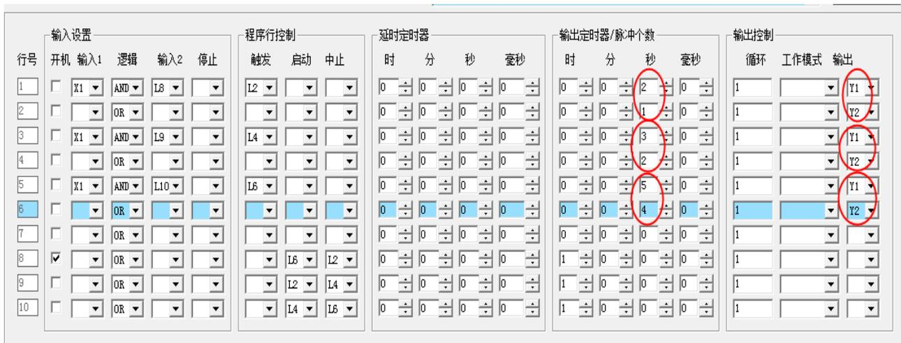
图中设置有三段程序, 由开关 X1 按照按键次数来分别启动来执行。此例每个步进只有两行程序, 举例说明设置原理, 实际应用中每个步进可由多行组成, 灵活运用。
