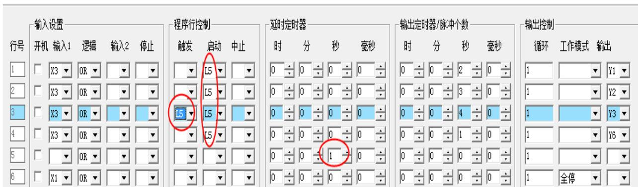
第 6 行设置 X1 为停止开关, X1 有效时全部输出停止工作全部关闭。
