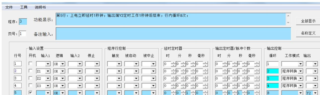
这是第三套程序的设置, 第 2、3、4 行分别设置用开关 X1、X2、X3 切换第 1、2、3 套程序, 第 5 行设置的是上电启动本套程序 Y2 工作的示意, 代表本套上电启动的程序。
