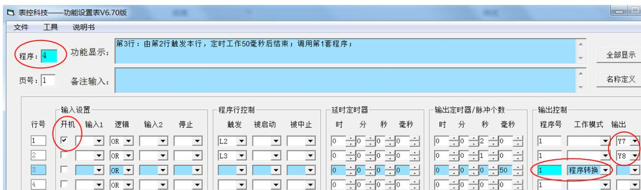
第 4 套程序设置为开机启动, 转换过来立即工作。程序号设置为程序 4, 执行完毕转为执行第 1 套程序设置为程序转换程序号 1, 输出设置为 Y7 工作 2 秒钟后触发第 2 行 Y8 工作 1 秒钟, 工作结束后触发第 3 行程序转换为第 1 套程序。第 1 套程序中使用 X1 开关再次启动程序顺序动作。
