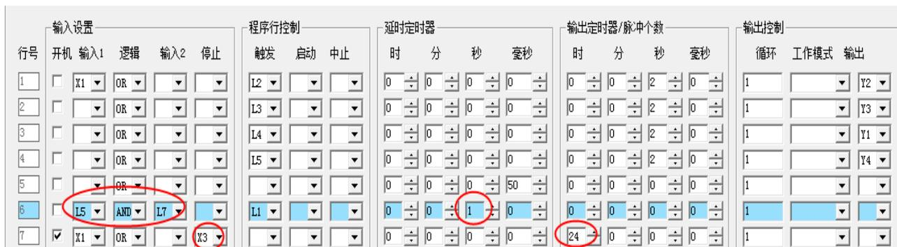
图中第 1—6 行是循环程序，其中第 6 行是循环控制行，只要第 6 行能够工作，延时 1 秒钟后就会触发第 1 行开始新的循环工作。第 6 行能否工作由其输入 2 的 L7 是否有效来决定。第 7 行的 L7 利用逻辑“与”（AND）控制第 6 行是否能够启动。
