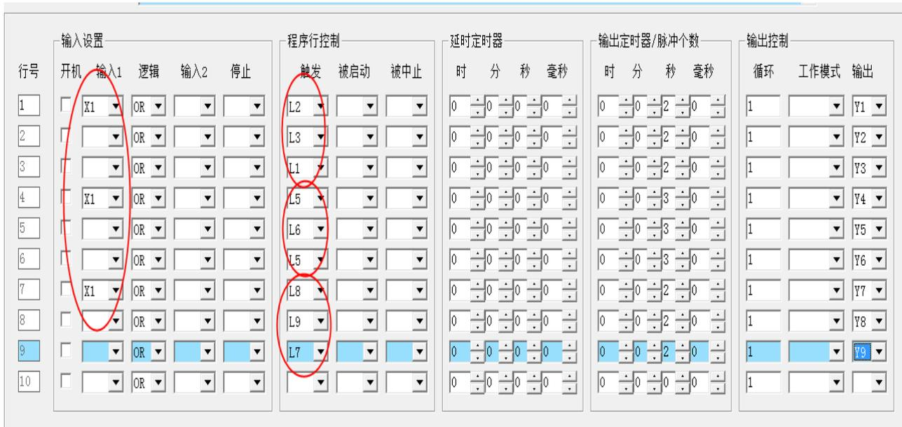
这是同时启动 3 个循环，每个循环顺序逐行执行。X1 同时启动 Y1——Y3、Y4——Y6 和 Y7——Y9 组成的三个独立的循环。
