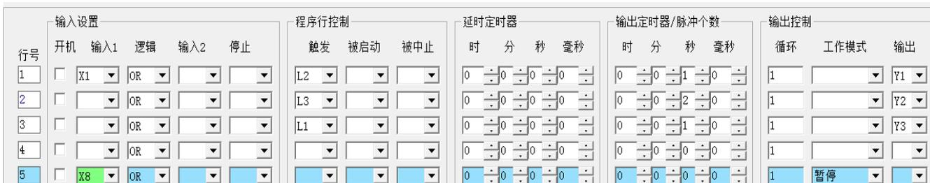
上面介绍的是暂停时输出保持的功能，暂停功能还有另一种暂停时输出不保持的功能，也就是暂停开关有效时所有输出端全部关闭，设置的差别是在输出定时器设置 50 毫秒作为标志。
