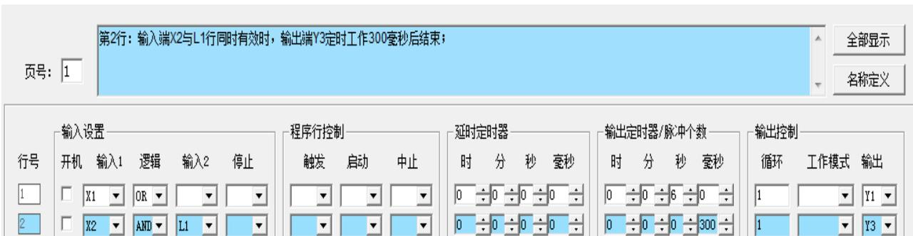
图中, 第 2 行的感应开关 X2 和第一行的行号 L1 组成逻辑“与”的关系, 只有 L1 有效的时候感应开关才能起作用。在气缸 Y1 进程的时候 L1 是有效的, 感应开关 X2 也有效。当回程的时候第一行停止工作 L1 无效, 因此, 感应开关 X2 被禁止, 第 2 行不能被启动工作。达到进程有效, 回程无效的功效。
