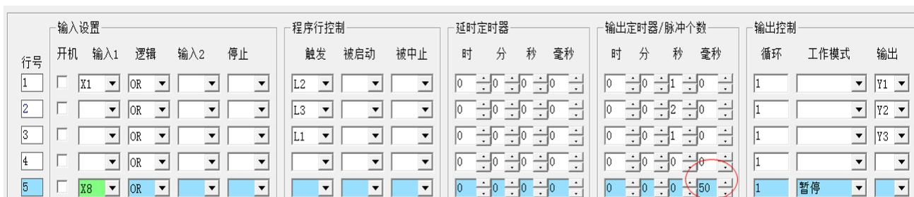
**手动**——通过设置任意一个输入端作为手动转换开关，还需要设置手动控制功能由输入端开关对输出端直接操作。全部程序只允许设置一个手动转换开关，允许设置多个手动操作开关。手动转换和手动按钮采用带自锁的按钮开关，手动转换开关接通时手动转换功能生效，立即停止全部程序的运行，停止全部定时器及输出端的工作，禁止所有输入端的功能，只允许设置为手动按钮的输入端执行手动功能。手动转换开关断开后手动功能失效。参见下图手动设置方法：
