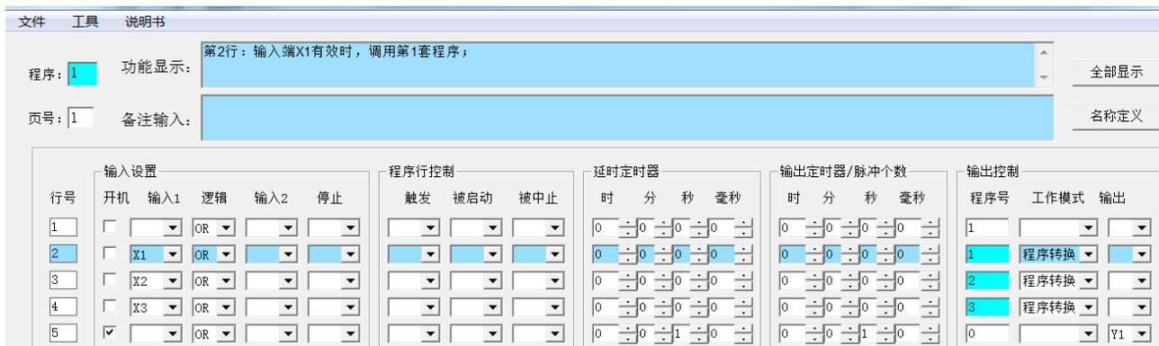
这是第一套程序的设置示例, 第 2、3、4 行分别设置用开关 X1、X2、X3 切换第 1、2、3 套程序, 第 5 行设置的是上电启动本套程序 Y1 工作的示意, 代表本套上电启动的程序。
