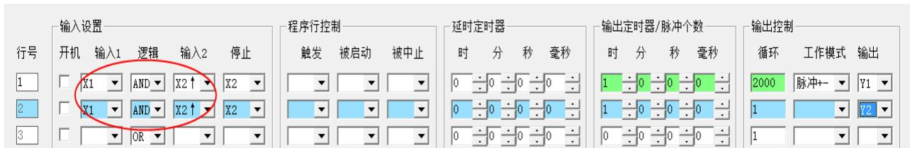
图中红圈部分，采用逻辑“与”（AND）的功能将启动按钮 X1 和感应开关的后沿 X2 ↑ 相与的结果是：X2 不在位的时候 X1 允许，X2 在位的时候 X1 被禁止。实现了原位感应开关 X2 在位的时候禁止回原位开关 X1 的功能，使重复的误操作不起作用。
