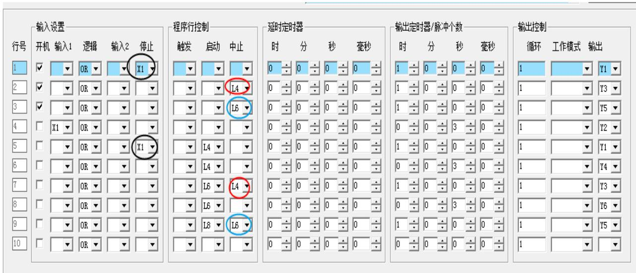
图中设置第 1、2、3 行开机自动启动，后面程序行根据需要设置有启动项，控制后面程序启动，其中，第 1、2、3、5、7、9 行输出定时器都是设置了较长的 1 小时的时间，这几行的工作是由停止开关和其他程序行中止来关闭的，因此设置了远大于实际工作时间的 1 小时。
