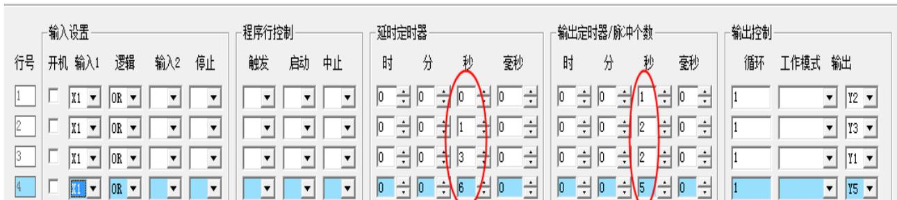
图中设置 4 行程序都由输入开关 X1 启动，每行设置了不同的延时定时器的时间，4 行同时启动，由于延时时间不同，因此每行的输出并不同时工作，延时定时器延时结束输出定时器才会自动执行定时，输出才会开始工作，直到各行的输出定时结束其输出自动关闭。
