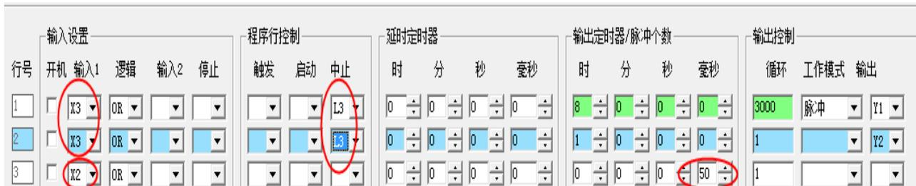
开关回原点与开机回原点原理相同，区别在于这里用开关实现回原点，主要用于在需要的时候手动操作开关来实现原点回归的功能。这里设置 X3 为回原点开关，X3 使用不带自锁的按钮开关。X2 是感应开关到位后第 3 行中止第 1、2 行步进电机的运行，电机停止在原位。
