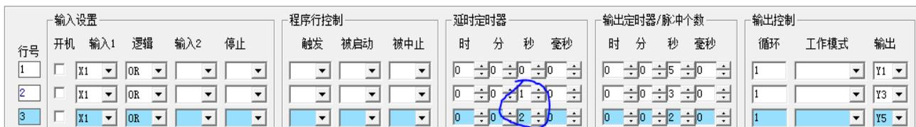
图中使用 X1 开关在第 1、2、3 行输入 1 设置用开关同时启动三行程序工作, 开关有效的时候这三行同时工作。可以根据每个动作实际需要设置延时时间, 参看图中篮圈设置的延时时间, 设置有延时时间的程序行启动后先进行延时, 延时后输出定时器和输出端开始工作。
