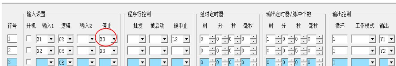
强迫停止后直接执行第 1 行停止项设置的 X3 停止第 1 行，代替程序行的中止功能。如果没有 X3 的强迫停止，第 2 行工作结束后仍然可以执行中止第 1 行的功能。
