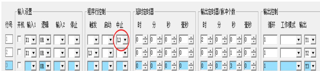
图中设置第 1 行和第 2 行由 X1 启动，第 1 行设置较长的时间 2 小时作为保持功能，第 2 行工作 1 秒钟结束触发第 3 行，第 3 行工作 3 秒钟结束中止第 1 行，强制关闭 Y1 输出及定时器的的工作。
