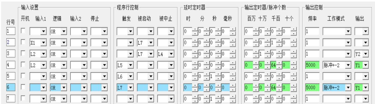
上图 X1 是启动开关，Y2 是方向输出端，Y1 是脉冲输出端，频率设置为 5000，脉冲数设置为 6400。步进电机驱动器的细分可以设置为 1600、3200 或 6400，细分不同转的圈数也不同。细分设置为 1600 转 4 圈，设置为 3200 转 2 圈，设置为 6400 时转 1 圈。以上细分适合步距角为 1.8° 的步进电机参考。
