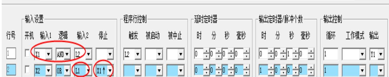
X1 是输入开关, X1 有效后 Y1 输出 1 秒钟, 如果 X1 持续时间超过 1 秒钟, X1 再次输入时候被禁止, X1 无效。X2 是控制条件的启动开关, X2 有效时启动第 2 行工作, 允许 X1 输入有效。
