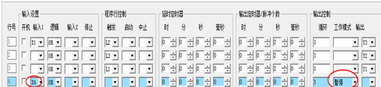
图中第 4 行设置 X4 为暂停开关，工作模式选择“暂停”项，暂停开关使用带自锁的按钮开关，开关按下全部程序暂停运行，保持当前工作状态。开关再次按下开关断开，暂停状态解除，程序继续运行。
