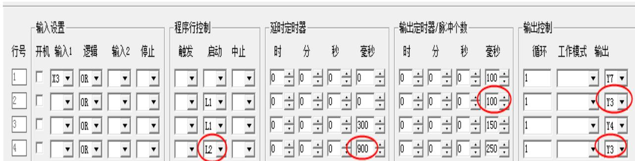
图中设置第 2 行的 Y3 执行完毕再启动第 4 行的 Y3，由于是第 2 行执行 100 毫秒后执行第 4 行，因此第 4 行延时 1 秒改为 900 毫秒，这样设置第 3 行和第 4 行的两个输出端是逐次执行的，避免了两行的输出端 Y3 同时执行的错误设置。
