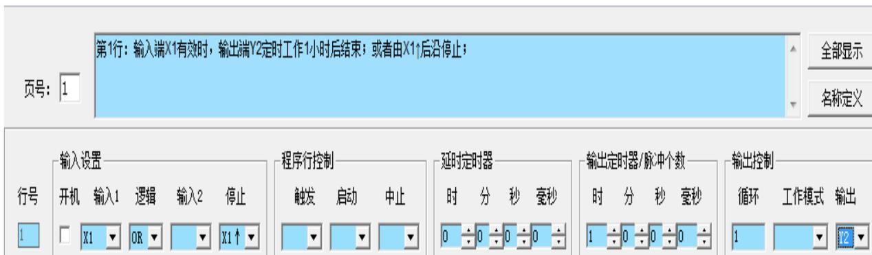
设置输入端前后沿的配合可以实现开关按下执行程序行松开停止程序行的功效。上图，设置输入 1 为 X1，停止项设置为 X1 的后沿“X1↑”，开关按下第行执行，开关松开第 1 行关闭。此方法同样可以应用于感应开关的控制中。
