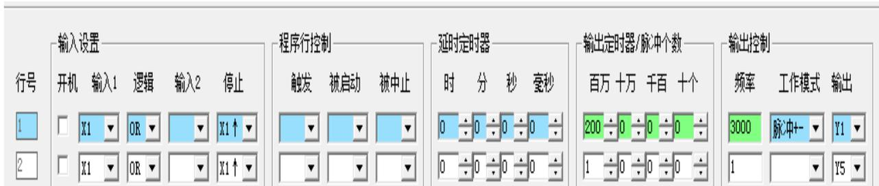
图中，第 1 行是脉冲由 Y1 输出，第 2 行是方向由 Y5 输出。X1 是自锁开关，控制两行同时启动和停止。两行设置输入 1 为 X1 启动，停止项为 X1 ↑ 后沿停止。启动后再次按下开关时 X1 释放，X1 ↑ 后沿起作用，停止这两行程序的工作，电机停止运行。
