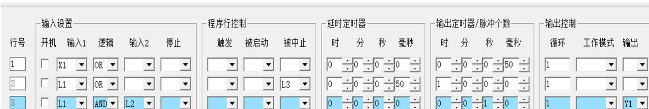
图中 X1 输入端的感应开关, 每输入一次信号输出定时器工作 50 毫秒, 将 X1 的信号转换为 50 毫秒的短信号, 有利于消除 X1 信号过长带来的影响。
