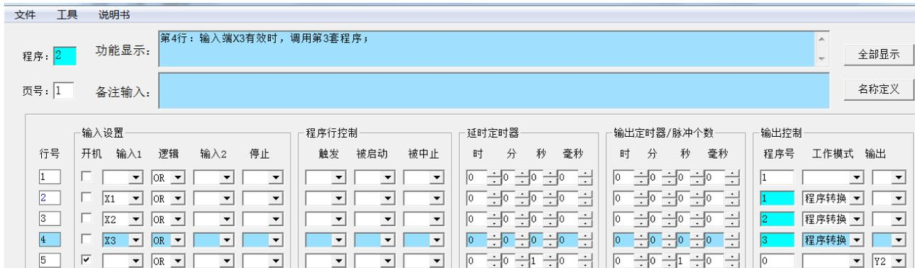
这是第二套程序的设置示例, 第 2、3、4 行分别设置用开关 X1、X2、X3 切换第 1、2、3 套程序, 第 5 行设置的是上电启动本套程序 Y2 工作的示意, 代表本套上电启动的程序。
