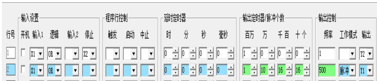
图中, Y1 作为脉冲输出, Y2 作为方向输出。第 2 行工作模式设置为“脉冲”模式, 光标在脉冲模式的第 2 行时, 脉冲频率项及脉冲个数输入项分别显示脉冲个数的单位, 数据输入框显示为绿色。脉冲输出单位为: 百万、十万、万、千、百、十、个, 脉冲频率的单位为赫
