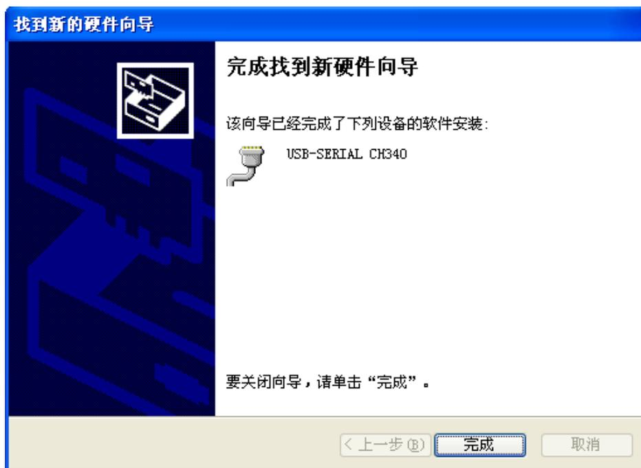
6、驱动安装成功后将“定时程序控制器”的下载电缆插到 USB 转 232 接口上, 下载电缆的另一端插到“定时程序控制器”的下载口中。
